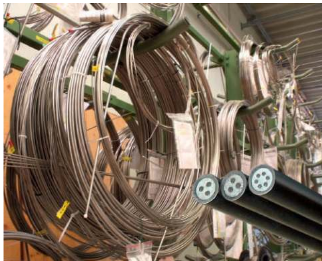
Câble gainé céramique (câble chemisé)
